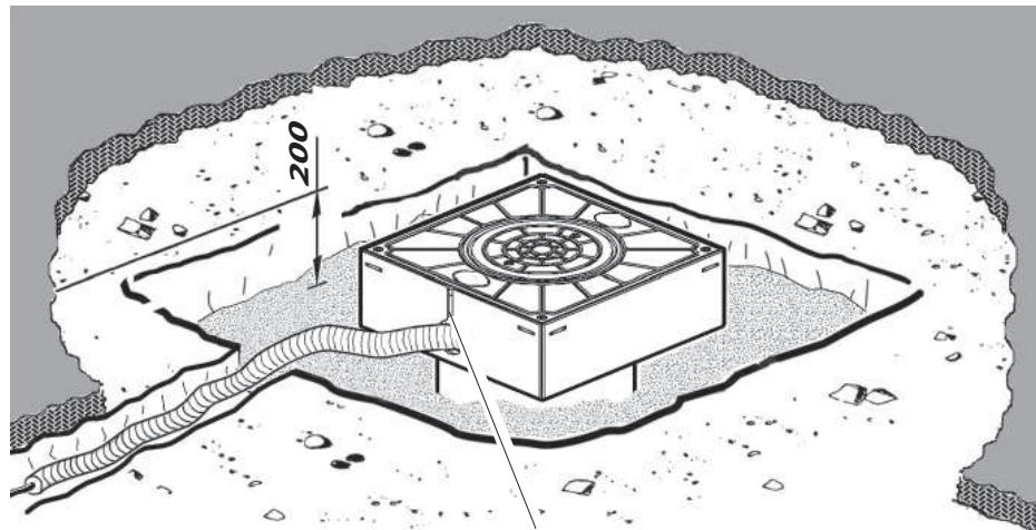
**Proteggere l'apertura del passaggio cavi con nastro adesivo**
